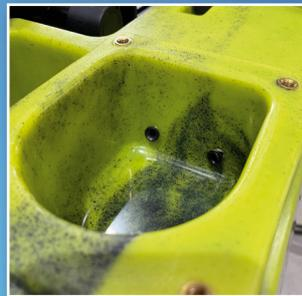
2. Im zweiten Schritt, musst Du die Abdeckung der Steuermechanik abbauen, um das Stahlseil aus den dafür vorgesehenen Kanälen zu entfernen. Löse alle vier Schrauben der Abdeckung, hebe sie an und das Stahlseil kann aus den Kanälen gezogen werden.
