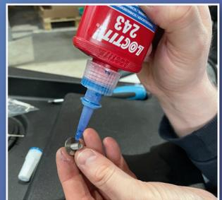
4. Du musst nun die Führungsrolle einmal umdrehen sodass die Löcher, aus denen Du die Splinte entfernt hast, auf der Unterseite der Mechanik liegen. Entferne die Fixierungsschraube und drehe dann die Rolle „auf den Kopf“. Achte unbedingt darauf, dass Du auch den kleinen Sicherheitsstein wieder einsetzt (Bild 3). Fixiere im Anschluss wieder alles mit der Sicherungsschraube und im Idealfall mit einem Tropfen Schraubensicherung.
