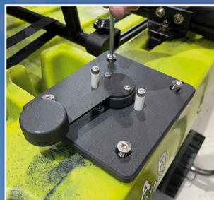
6. Im nächsten Schritt musst du die Dynamaseile an der Steuermechanik fixieren! Achte darauf, dass sich die Seile im vorderen Bereich der Lenkrolle kreuzen (Bild 3)! Zur Fixierung reicht ein einfacher Hausfrauen- oder ein Achterknoten unterhalb des Lochs – Schneide überflüssiges Seil nah am Knoten ab.
