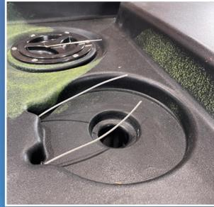
1. Entferne die Steering Disk mit den entsprechenden Inbus-Schlüsseln. Löse dafür sowohl das Ruderblatt, als auch die kleinen Madenschrauben, die das Steuerseil an der Disk fixieren! Dann kannst Du die Disk entfernen.
