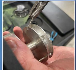
3. Entferne nun das Stahlseil samt der dazugehörigen Fixierung von der Steuereinheit. Löse die Madenschraube wie angezeigt und ziehe das Seil aus der Führung. Entferne im Anschluss die Fixierung! Sollte das Fixierungs-Inlay zu fest sitzen, kannst Du sie ruckartig mit Hilfe des noch eingefassten Seils herausziehen. Danach kannst Du auch die Splinte links und rechts von der Fixierung entfernen.
