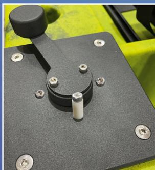
9. Im letzten Schritt müssen die beiden Begrenzer, die ein Übersteuern verhindern Links und Rechts des Steuerhebels entfernt werden. Einen der beiden Begrenzer solltest Du wie auf dem Bild nach Hinten umsetzen und die beiden entstandenen Löcher mit den beiden kurzen Schrauben verschließen. Jetzt ist dein Kajak wieder einsatzbereit und wir wünschen viel Spaß auf dem Wasser und natürlich
