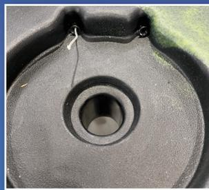
5. Teile das mitgelieferte Dynamaseil in der Mitte und erhitze die beiden Enden sodass sich die Fasern miteinander verbinden und nicht ausfransen. Führe nun beide Seile in die Kanäle ein bis sie am Platz für die neue Steering Disk wieder herauskommen.
