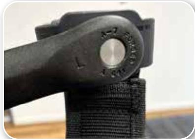
Die Enden der Achse, auf der Du die Kurbeln montierst laufen konisch zu. Hier musst Du mit dem mitgelieferten Inbus wirklich Kraft anwenden, um die Kurbeln ausreichend auf der Achse zu fixieren.
