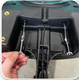
**03.** Führe die Enden der Steuerseile links und rechts an den dafür vorgesehenen Öffnungen an der Steueranlage ein und drehe anschließend die Flügelmuttern wieder auf. Je fester Du die Muttern anziehst, desto straffer spannt automatisch Du auch die Steuerseile. Achte unbedingt darauf, dass der Steuerhebel die ganze Zeit gerade nach vorne zeigt. – suche Dir im Zweifelsfall eine helfende Hand.
