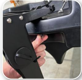
**02.** Bringe den Steuerhebel in die Mittelstellung und löse hinten am ende der beiden Steuerseile die beiden Flügelmuttern.
