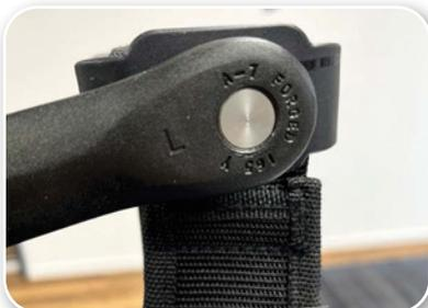
Solltest Du die Kurbeln einmal demontieren wollen, versuche bitte nicht diese einfach abzuhebeln. Benötigt wird hier ein Kurbelabzieher – jedes Fahrrad Fachgeschäft kann Dir hier behilflich sein.
